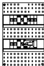
Installatiekast 6x achter 3x 30mA + hoofdschakelaar 3-fase
