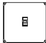
Huisaansluitkast met 1 installatieautomaat
