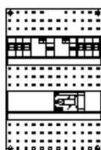
Installatiekast 6x achter 2x 30mA + hoofdschakelaar 3-fase
