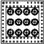
Installatiekast schroefpatroonhouders 4x (3x 25A)
