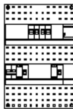
Installatiekast 4x achter 2x 30mA + T + hoofdschakelaar 1-fase
