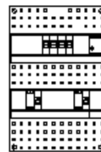
Installatiekast 4x achter 2x 30mA + T 1-fase
