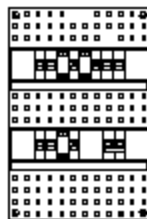
Installatiekast 6x achter 3x 30mA + hoofdschakelaar 1-fase
