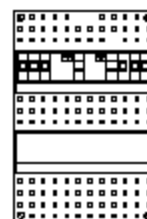
Installatiekast 6x achter 2x 30mA 3-fase
